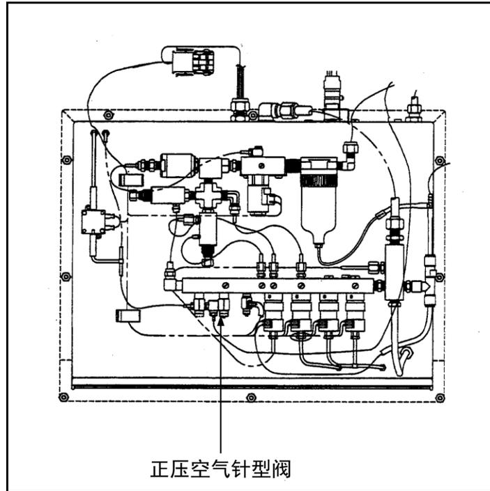
**图 8-16. 调节正压空气针型阀**
